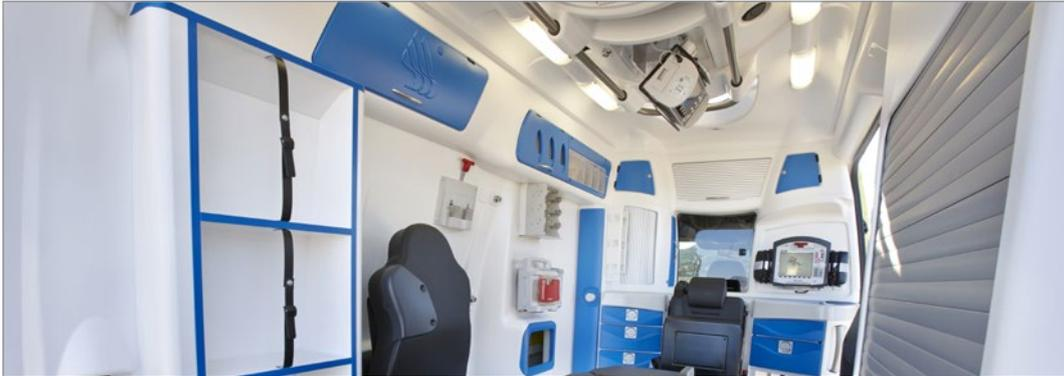
El mobiliario Bercomplex desarrollado por Bergadana permite evitar la deformidad provocada por el tiempo y la degradación provocada por los fluidos o líquidos que se utilizan en la propia ambulancia.
