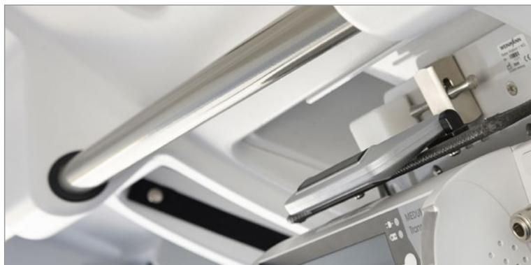
Instalación de distintas barras de acero inoxidable en los accesos del vehículo para facilitar la entrada y la sujeción de personal sanitario.
